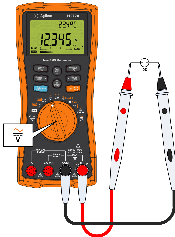
Figura 2-6 Medición de tensión de CC
