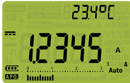
Figura 2-29 Visualización de corriente CC
