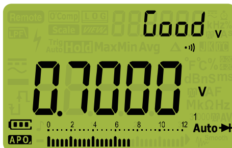
Figura 2-22 Visualización de autocomprobación de diodo - Estado: Good (Bien)
