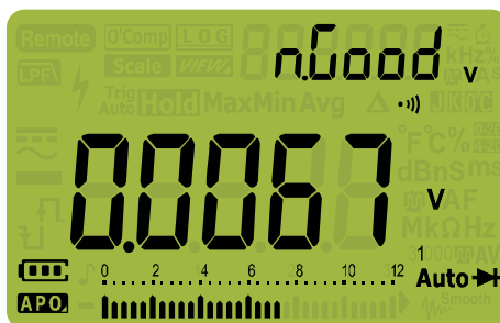
Figura 2-23 Visualización de autocomprobación de diodo - Estado: nGood (No muy bien)
