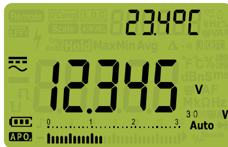
Figura 2-7 Visualización de la tensión de CA+CC
