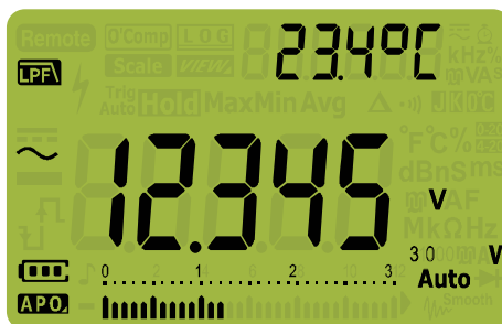
Figura 2-3 Tensión de CA con visualización de LPF
