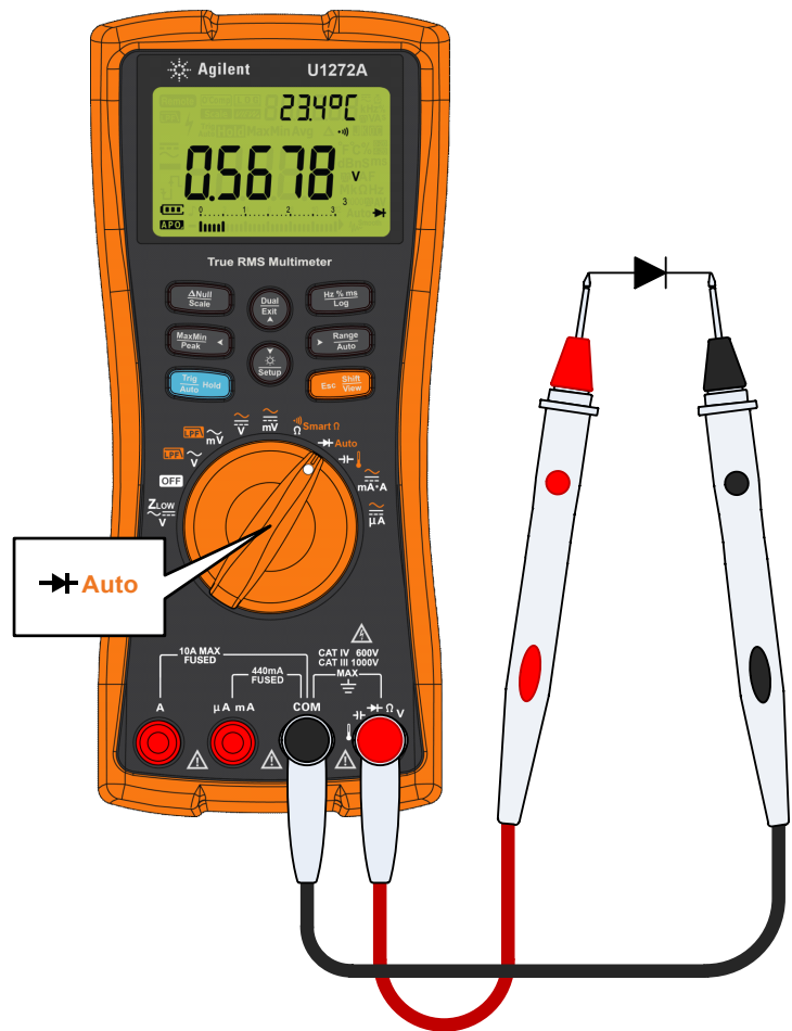
Figura 2-20 Prueba de diodo de polarización directa
