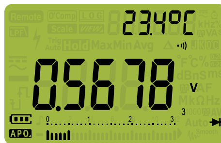
Figura 2-18 Visualización de diodo
