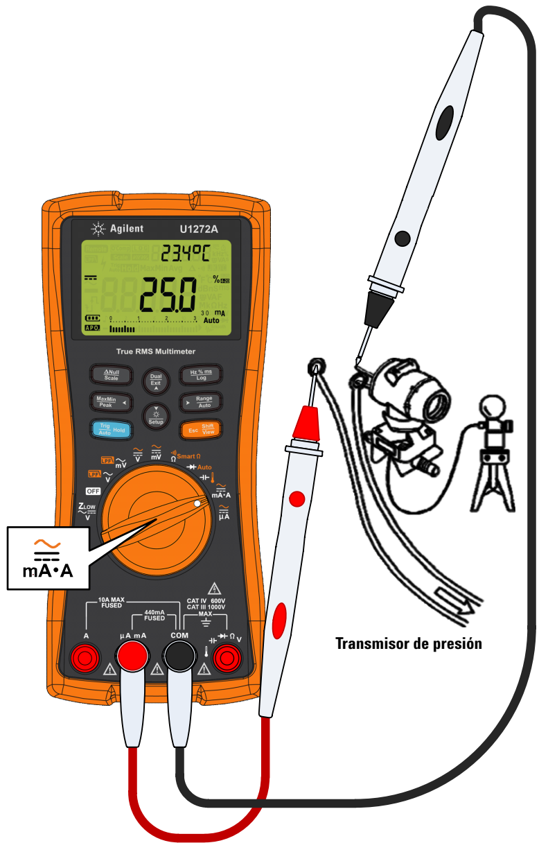
Figura 2-34 Medición de corriente cc utilizando la escala de % 4-20 mA
