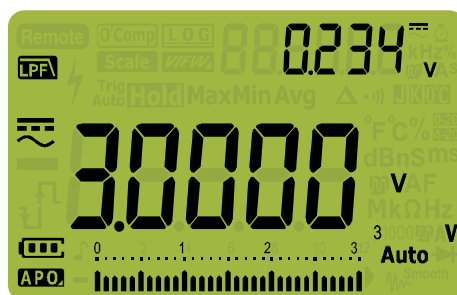
Figura 2-4 Acoplamiento de CC para mediciones de tensión de CA + CC
