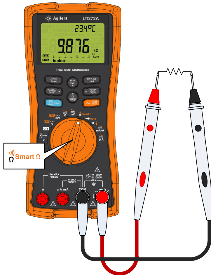
Figura 2-13 Medición de resistencia
