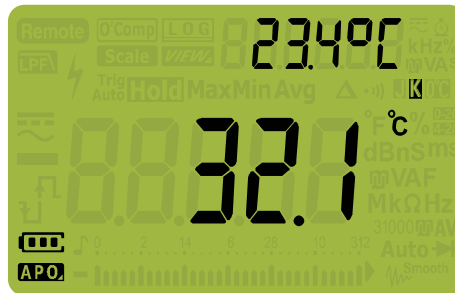
Figura 2-26 Visualización de temperatura
