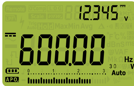
Figura 2-37 Visualización de frecuencia
