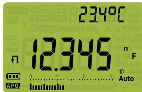
Figura 2-24 Visualización de capacitancia
